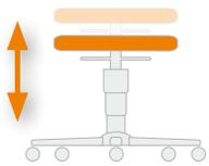
Sitzhöhenverstellung durch Gasfeder mit Ringauslösung
